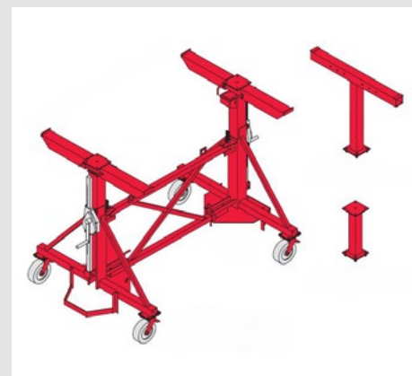
Ausschalwagen mit Aufstockung 1.00 m/0.60 m für Raumhöhen von 1.45 m bis 5.22 m (UK Beton)
