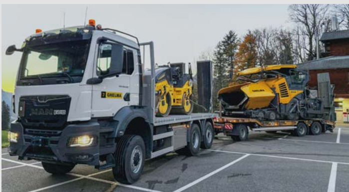
Der typische Belagsmaschinenzügel mit Fertiger und 5 t Walze
