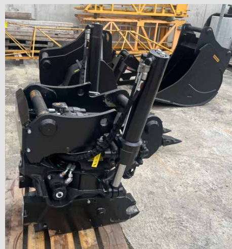
Abgebauter Rototilt als «Sandwich»
